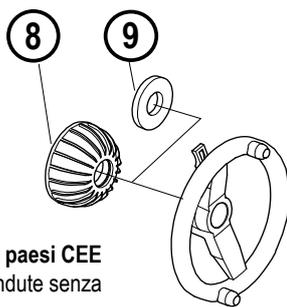
Obbligatoria nei paesi CEE per macchine vendute senza protezione ruota (velocità inferiore a 100 1/min)
