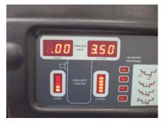
REMOVE THE CALIBRATION WEIGHT (100 GRAM/3.5 OZ.) AND WHEEL. THE BALANCER IS NOW CALIBRATED AND READY FOR USE.
