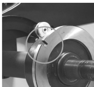
Рисунок 2.7а - Пазы для крепления адаптеров
